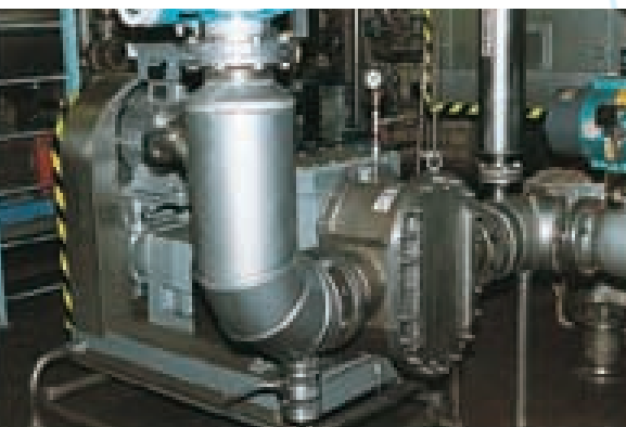
Pompa FKL 600 do pompowania zawiesin kleju i farb w zakładach Hoechsta / Frankfurt.
